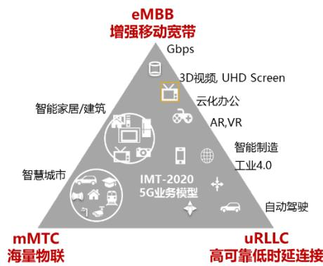
其中eMBB要求把单用户的接入峰值速率提到1Gbps，uRLLC要求业务端到端超低时延1ms，mMTC要求在每平方公里的连接数可以达到一百万。这三大业务场景的定义是由5G诸多新技术做为实现支撑，比如Massive MIMO，新的空口编码，控制面和转发面分离，核心网分层次部署等，其中网络切片技术是实现5G时代业务隔离，端到端超低时延的基础。
