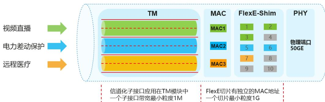
信道化子接口技术作用于承载设备的TM模块中。根据业务的SLA要求，为每个业务分配相应的硬件缓存资源，相当于在TM模块中为每个业务划分车道，业务车道之间是实线，业务流量传输过程中不能并线换车道，业务为车道之内是虚线，采用QoS技术进行缓存调度。业务车道的最小粒度是1M。缓存资源的独占，使得各个业务在TM模块中得到硬隔离，有效避免流量突发时，出现各业务争抢缓存资源，导致业务SLA劣化。
