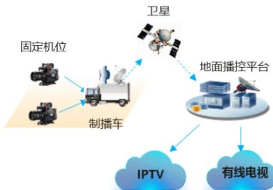
高清视频直播一般都是由事件驱动，比如两会、春晚外场、体育赛事、现场演唱会、游园会，或其他突发事件。视频清晰度要求高、突发临时性和场地不确定性是这类业务的主要特点。传统做法是在直播现场部署一台装备着制作播放设备和卫星通讯设备的制播车，现场编辑由多个固定机位摄像机拍摄的视频，制作成直播节目并通过卫星回传到地面播控平台，然后再分发到不同的直播网络中。
