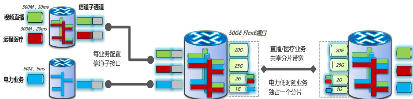
在承载网接入层的低成本设备上，为每个业务按照SLA的要求分别配置一个信道化子接口，例如视频直播信道CIR（承诺保障速率）500M，远程医疗信道CIR 300M，电力业务信道CIR 50M。业务流量经各自的信道子接口传输到汇聚层设备。汇聚层设备根据各业务的SLA，将业务信道子接口跟相应的FlexE切片绑定，比如将要求大带宽的视频直播和远程医疗绑定到一个2G的切片，将要求低时延的电力业务绑定到一个1G的切片。业务信道子接口嵌套在FlexE切片中，业务流量在硬管道中传输，直到承载网络出口。
