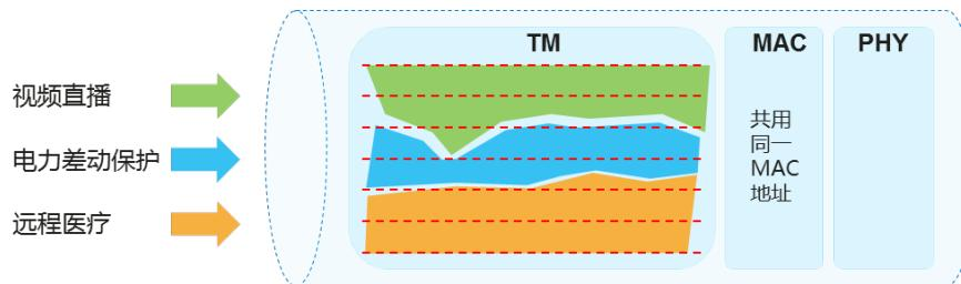
视频直播、远程医疗和电力差动保护三个业务同时在一个承载网管道里传输数据，绿色、蓝色、橙色分别代表这三种业务的VPN流量。承载设备内的TM模块（流量管理）负责不同业务的QoS处理，红色虚线代表不同的QoS缓存队列。可以这样简单的理解：QoS技术在一个管道中划分出不同的车道，业务流量根据优先级，在相应的车道中传输。每个车道代表一定大小的缓存队列，车道分割线是虚线，在QoS优先级调度机制的作用下，业务流量可以变更车道。由于缓存资源和MAC地址对各个业务来说都是共享的，当流量突发时，各业务间互相抢占资源，不可避免的会产生拥塞现象，业务的SLA也就无从保证。
