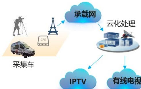
直播现场不再部署专用的制播车，活动机位摄像机（摄像师或视频采集车）与CPE连接，将拍摄到的视频通过5G基站经承载网/核心网回传到制播中心进行云化处理，然后再分发到不同的直播网络中。活动机位可以灵活移动，从不同角度捕捉到更多的视频信息，制播云化处理可以节省数百万的车载制播设备和卫星通讯设备。
