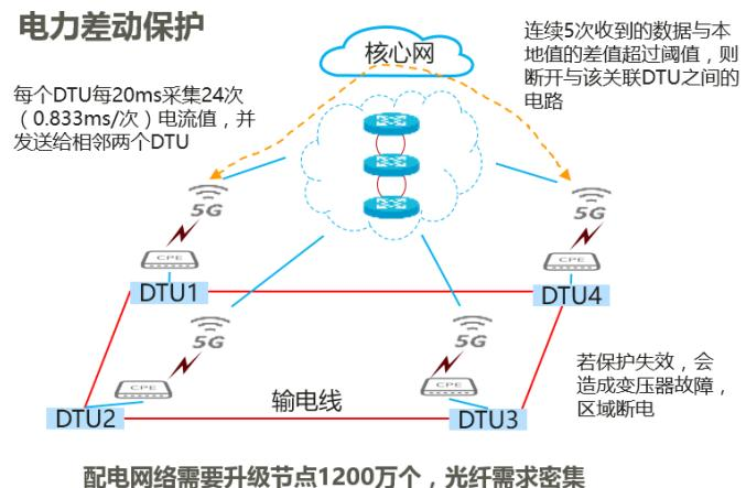
电力的配电网络由配电站和输电线组成，一般配电站里面会有输电设备、变压器、配电保护设备(DTU)等。如果全网按照有线连接的方式部署差动保护，光纤需求量大成本高。按照目前差动保护业务的要求，每个DTU每隔20ms采集24次(0.833ms/次)本地电流值，通过5G网络发送给关联的DTU。如果一个DTU连续5次收到的电流值与本地的差值超过阈值，则认为发送端有故障，断开相连的电路以保护设备和供电安全。从试验站点测试结果上看，5G网络端到端时延15ms，带宽5M，即可满足差动保护业务要求。
