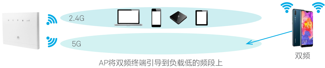
Band steering 工作原理示意图
