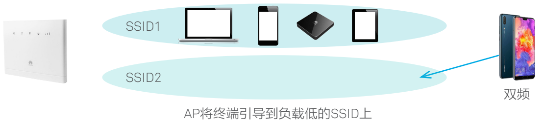
SSID Steering 工作原理示意图
