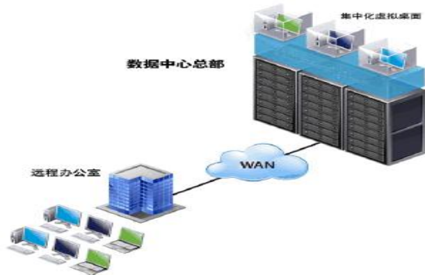
图2-3 集中式部署的分支机构方案
