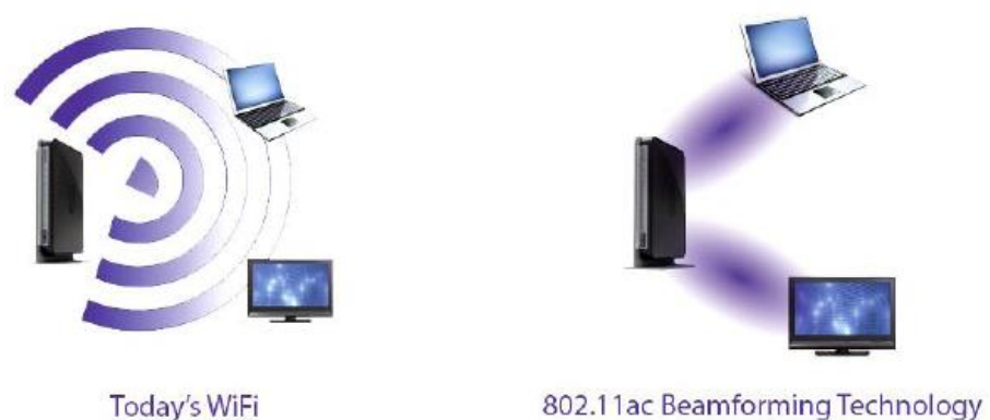
图4-9 Beamforming 工作原理示意图
