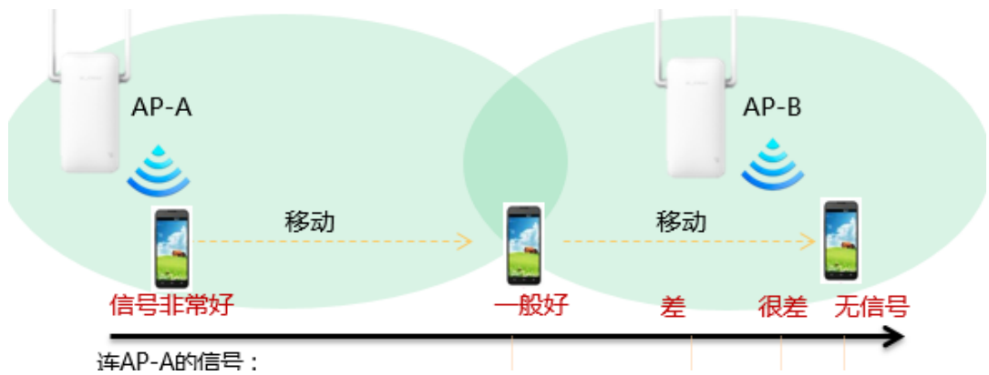
图2-4 终端设备移动对 Wi-Fi 质量的影响示意图
