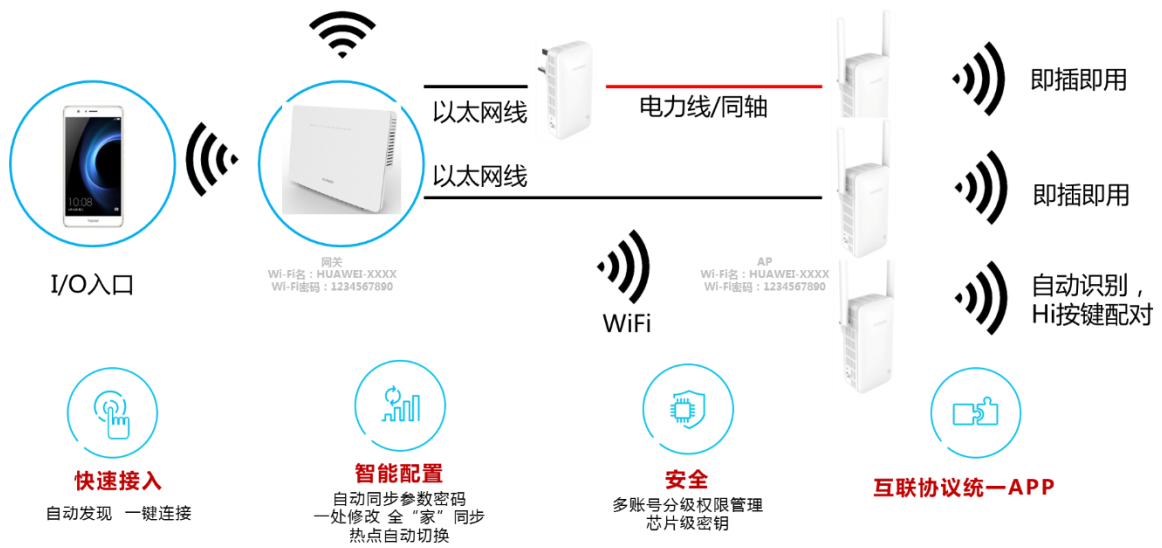
图5-11 网关和 AP 即插即用示意图
