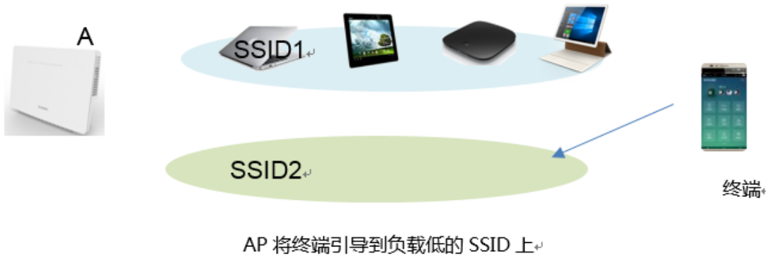
图4-6 SSID Steering 工作原理示意图
