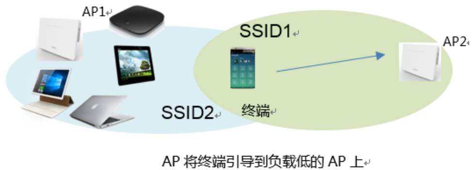
图4-7 AP Steering 工作原理示意图
